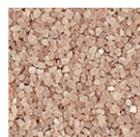
La **speciale sabbia filtrante di Ospa** con la sua ruvida struttura superficiale, è in grado di assorbire una quantità nettamente maggiore di particelle sospese rispetto al materiale filtrante artificiale, rendendo l'acqua cristallina.
